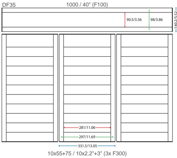
■ Visible insert ■ Insert width ■ Sign width (mm/in)
