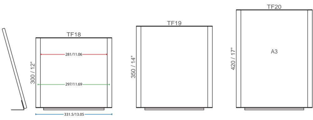
■ Visible insert ■ Insert width ■ Sign width (mm/in)
